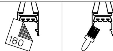
**Wichtig!** Die Schnittstellen sind umfassend von Sägerückständen zu säubern! Verbleibende Späne können im Profil zu Spannungsüberschlägen führen.
