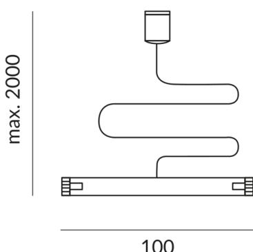
contre l'affaissement des systèmes de rails plus longs avec un carton décalable de 100mm, câble en acier de 2 m inclus, raccordable
