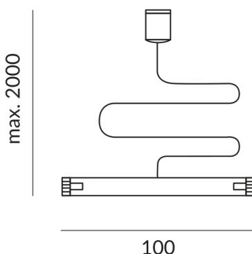
contre l'affaissement des systèmes de rails plus longs avec un câble en acier de 2 m inclus, raccourcible
