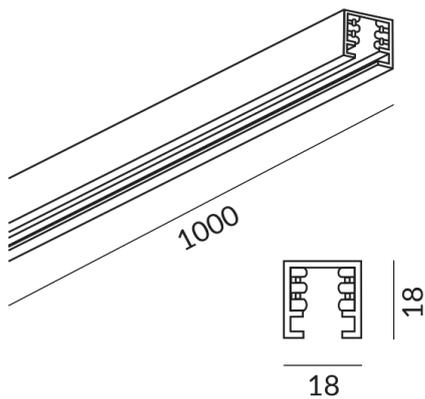
Aluminiumstromschiene mit 4 isolierten Kupferleitern 2,5 mm und Schutzleiter. Isolierprofil schwarz, ohne Endkappen. Die DUOLARE Stromschiene besteht aus einem stranggepressten Aluminiumprofil mit eloxierter Oberfläche in mattchrom, chrom und weiß.
